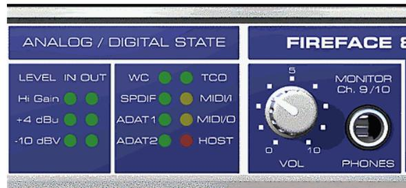
Die rote LED **HOST** leuchtet nach Einschalten des Fireface 800 rot auf und signalisiert damit zunächst eine vorhandene Betriebsspannung. Gleichzeitig dient sie als Fehler-LED, wenn die FireWire-Verbindung noch nicht initialisiert wurde, oder unterbrochen wurde (Error, Kabel nicht gesteckt etc.).
