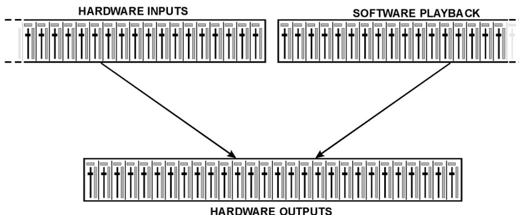
TotalMix kann in der obigen Ansicht (View Options **2 Row**) platzsparend arbeiten. Default ist jedoch eine vertikale Anordnung wie bei einer Inline-Konsole, wobei die Reihe *Software Playback* dem *Tape Return* eines realen Mischpultes entspricht:
