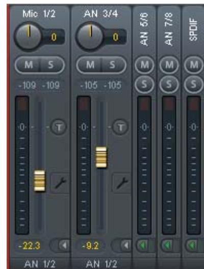
Mit dem **Pfeilsymbol** lässt sich ein Kanal horizontal verkleinern, so dass nur noch die Level Meter zu sehen sind. Ein Mausklick bei gedrückter Strg-Taste führt zum Ein- und Ausklappen aller weiter rechts befindlichen Kanäle.
