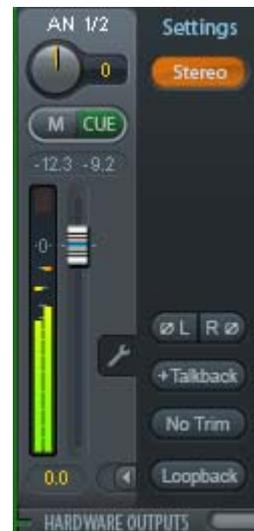
Ein weiterer Unterschied zu den Eingangs- und Playback-Kanälen ist der Taster **Cue** statt Solo. Ein Klick auf Cue schaltet den entsprechenden Hardware Output auf den **Main** Out, oder einen der Phones Outs (Option *Assign / Cue to* in der Control Room Sektion). Damit lässt sich jeder Hardwareausgang bequem über den Monitorausgang kontrollieren und abhören.
