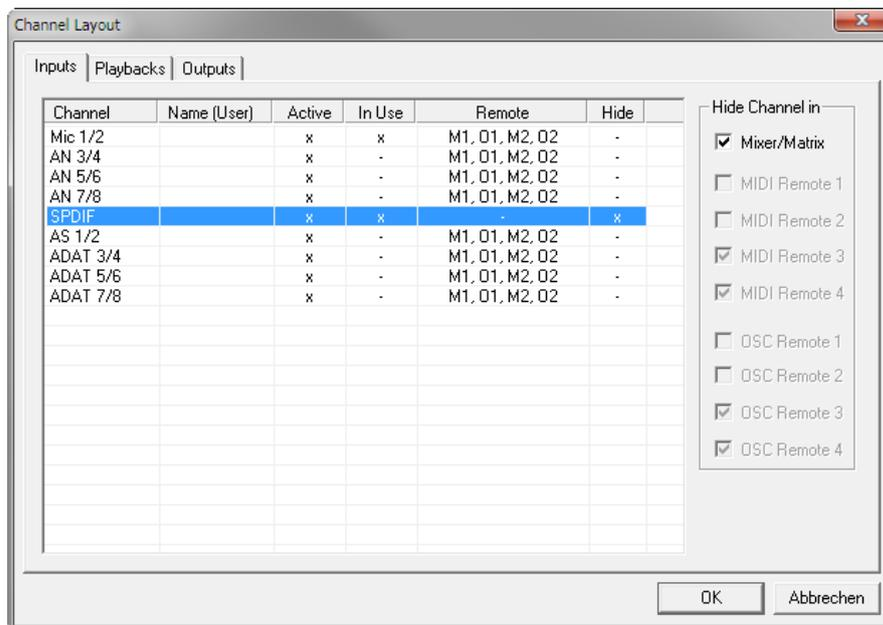
Die Reihen Inputs, Playbacks und Outputs haben jeweils eine eigene Seite, mit Zugriff über die Reiter oben. *Active* zeigt derzeit verfügbare Kanäle. Bei höheren Samplefrequenzen sind viele ADAT-Kanäle nicht länger verfügbar. *In Use* zeigt die derzeit im Mix verwendeten Kanäle.
