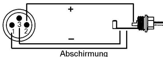
Die Trafosymmetrierung des koaxialen Ein- und Ausgangs bietet neben dem problemlosen Anschluss eines AES/EBU-Gerätes eine sichere Vermeidung von Brummschleifen.
