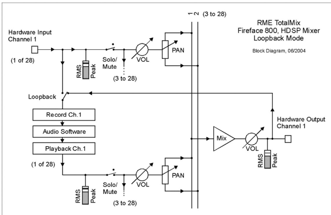
Das Blockschaltbild zeigt, wie das Eingangssignal der Software über Playback ausgegeben, und von dort über den Hardware Output zurück zum Softwareeingang gelangt.
